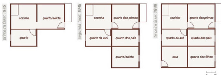
Figura 2: Esquema gráfico da planta da casa em suas fases de construção, a partir das informações coletadas nas entrevistas (PALMEIRA, 2021)
